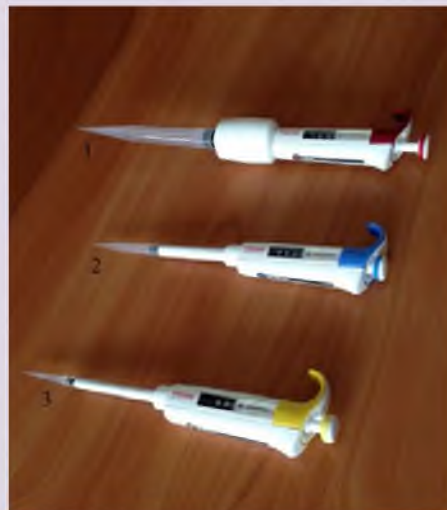
Рис. 7. Пипетки-дозаторы одноканальные переменного объёма: 1 — 1—10 мл; 2 — 100—1000 мкл; 3 — 10—100 мкл.
