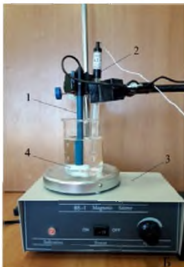
Рис. 2. Установка для определения концентрации (активности) хлорид-ионов в растворе.
